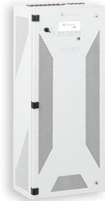
Steuergerät mit Touchpanel. Es überwacht die korrekte Funktion von Notbeleuchtungsgeräten, bestimmt deren Zustand durch automatische Funktions- und Autonomietests und überprüft die Richtigkeit der Parameter. Mit dieser Lösung sind Informationen über alle Stromkreise und Leuchten, die im an das System angeschlossenen Gebäude installiert sind, für den Benutzer an einem Ort einfach und schnell zugänglich.
